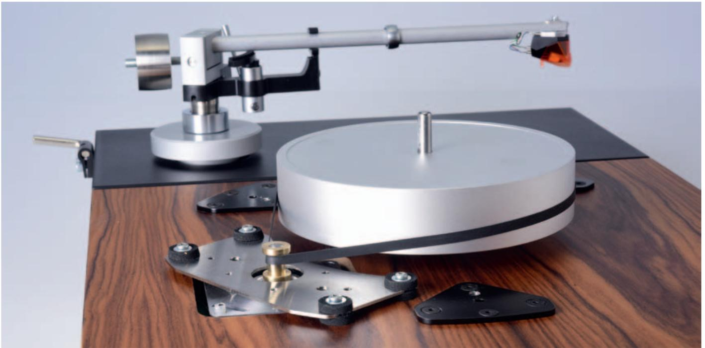
Dämpfung überall: Ein breiter Riemen besorgt die Kraftübertragung zwischen Motor (vorn links) und Subteller. Besonderheit: Nicht nur sind Tellerlager und Armbasis über das interne Subchassis federnd gelagert, sondern auch zwischen Außenchassis und Motorplatte und nochmal zum eingeklebten Motor finden sich Sorbothandämpfer. Die schwarzen Platten dienen der Aufnahme der sechs Transportsicherungsschrauben.
